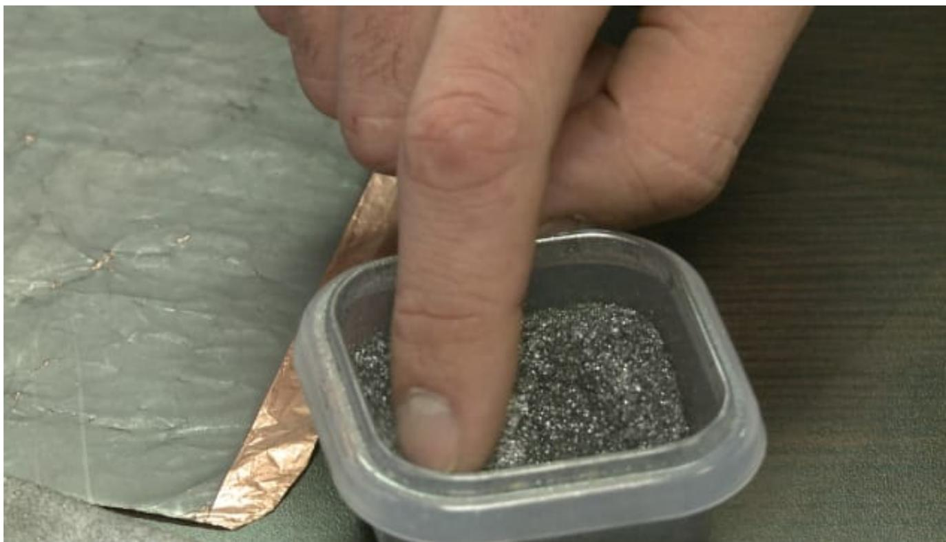
Le graphite est principalement utilisé dans la composition de matériaux et de pièces dites « réfractaires », c'est à dire résistantes à de très fortes températures. On l'utilise aussi, notamment, dans la fabrication de piles au lithium-ion.
